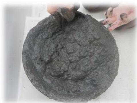
Homogénéisation du sédiment (mélange de tous les prélèvements élémentaires)
