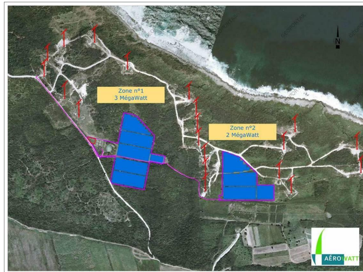
Figure 18 : Implantation de la centrale photovoltaïque de Fonds Caraïbes
