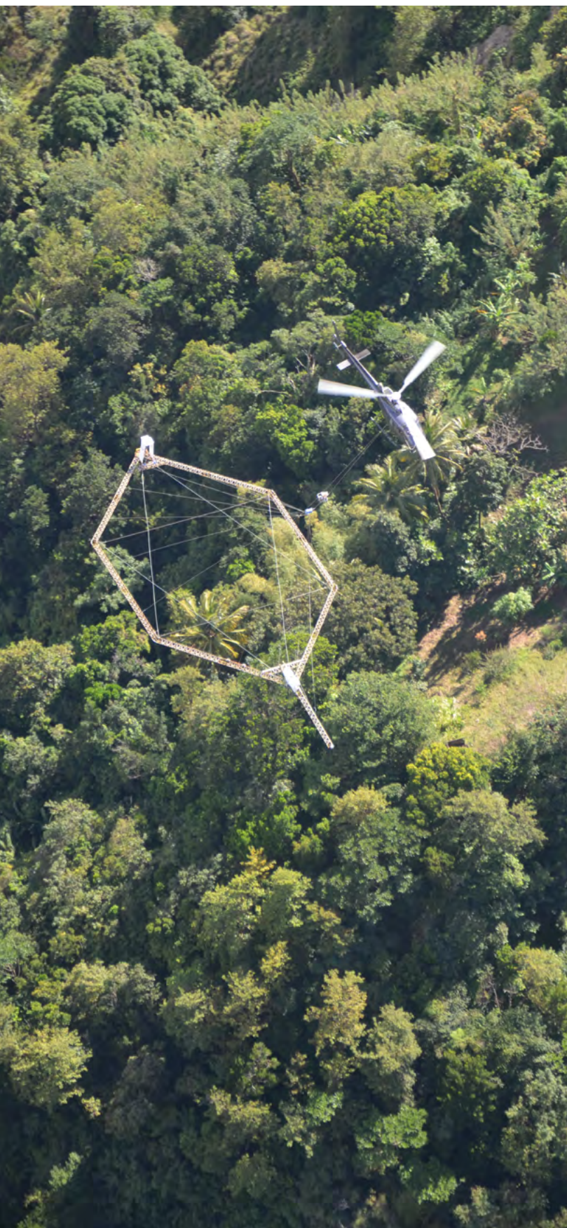
Levé géophysique électromagnétique aéroporté dans le cadre du projet GUADEM.
