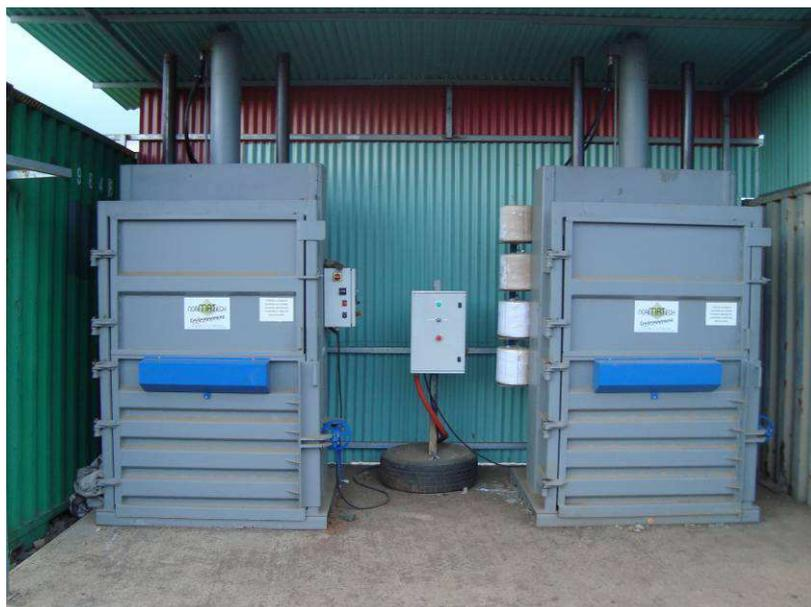
**Figure 3. Photo presses à balles**
