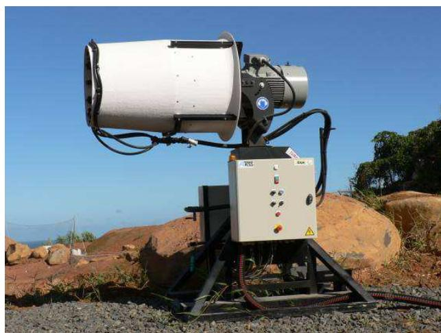
**Figure 9. Photo d'un canon pulvérisateur de produit neutralisant**
