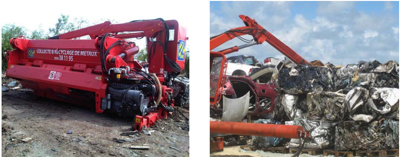
Figure 31 : Photos illustrant l'unité mobile de compactage des VHU de la SNR (Source : CARAIBES ENVIRONNEMENT)
