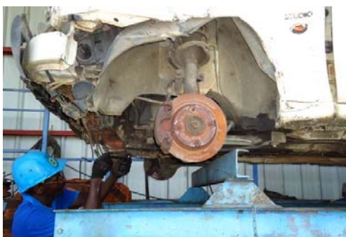
Figure 37 : Photos illustrant les étapes de dépollution des VHU effectuées sur le site d'AER : 1. Stockage des pare-chocs – 2. Démontage des pneumatiques – 3. Vidange des liquides polluants – 4. Stockage des batteries (Source : AER et CARAIBES ENVIRONNEMENT)
