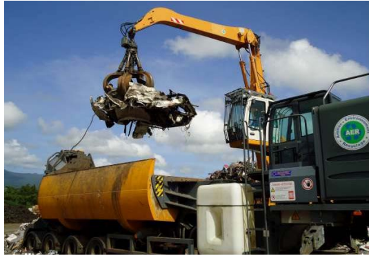
Figure 38 : Photos illustrant les étapes de prétraitement des VHU effectuées sur le site d'AER : 1. Cisailage des VHU – 2. Balles de VHU (Source : AER)
