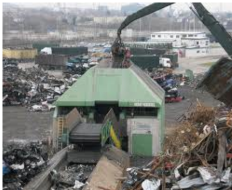
Figure 50 : Photos illustrant les installations de GDE à Limay 1. Pré-broyeur – 2. Broyeur à GDE (Source : gderecyclage.com)
