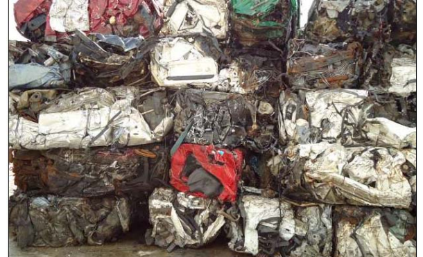
Figure 38 : Photos illustrant les étapes de prétraitement des VHU effectuées sur le site d'AER : 1. Cisailage des VHU – 2. Balles de VHU (Source : AER)
