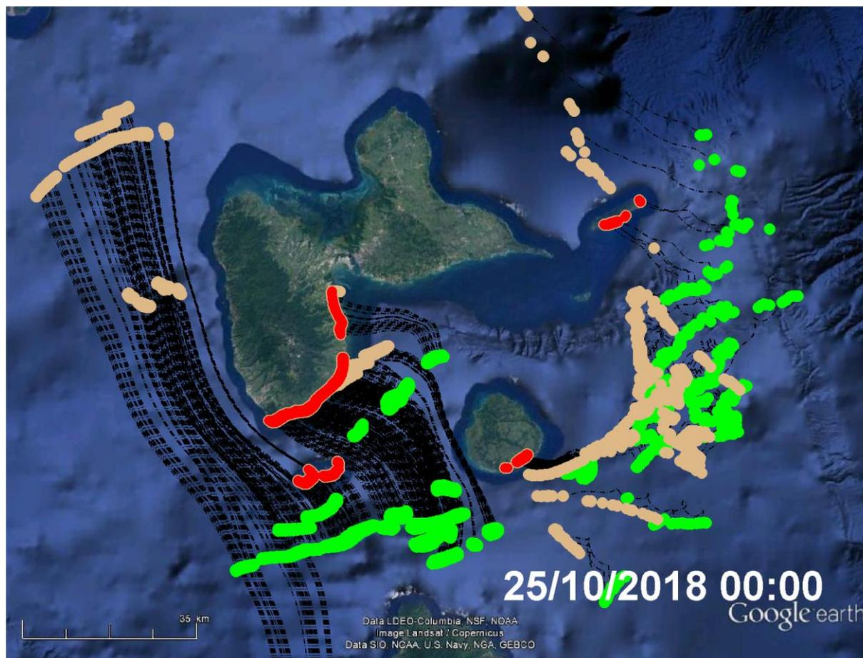
Figure 3 Radeaux de sargasses, positions de détection (points verts), trajectoires (pointillés blancs), positions le 25/10/2018 à 00:00 (heure locale) et positions d'échouages prévues (points rouges) sur les îles du Nord.
