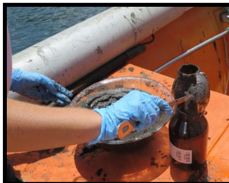
Conditionnement dans le flaconnage transmis par le laboratoire
