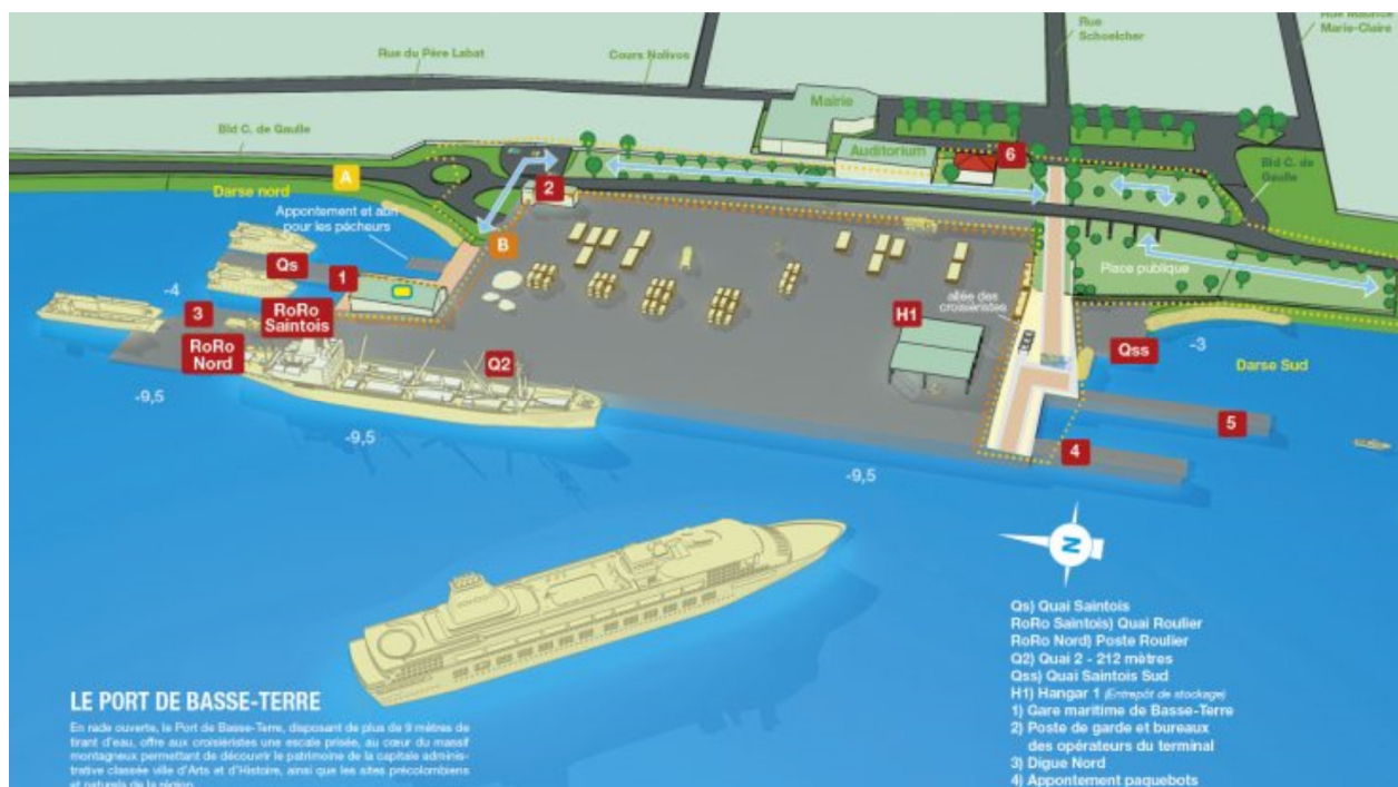
Figure 18 : Configuration du port de Basse-Terre (source : guadeloupe-portcaraibes.com)
