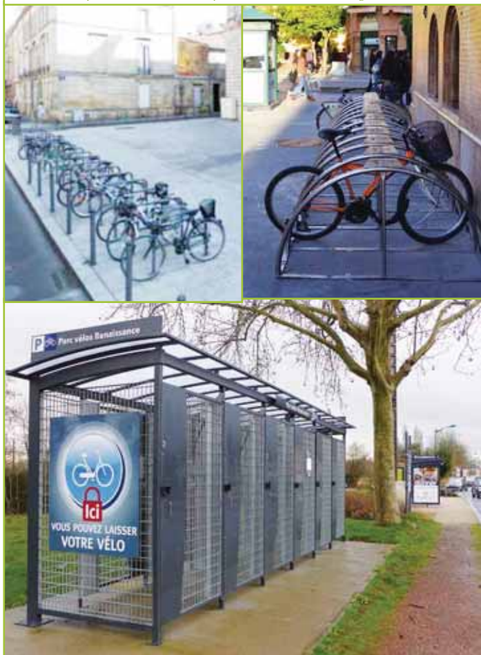
Exemples de stationnements permettant d'éviter le voilage des roues
