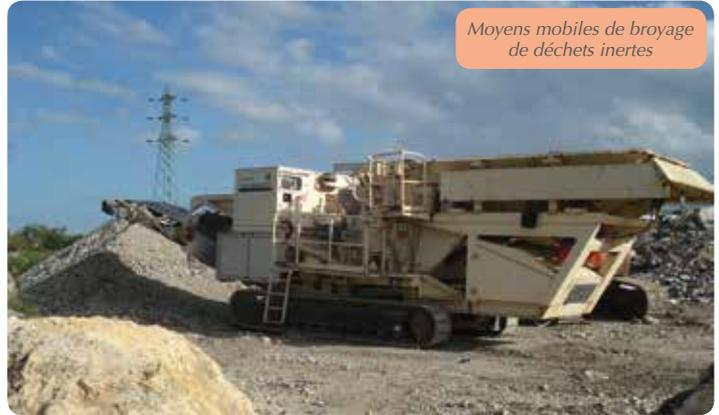
alors être traités (concassage, criblage...) en vue d'une réutilisation dans les travaux routiers (assise de chaussée, terrassements, remblais, couche de forme...).
