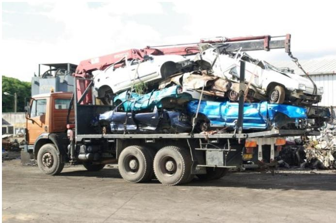
Figure 34: un camion SNR pour le transport des épaves, (source Catram)
