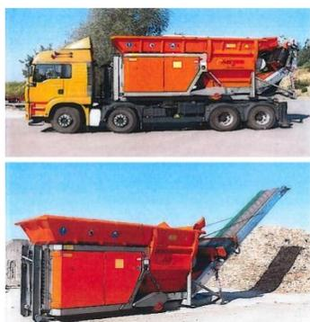
Figure 12: broyeur lent (pour broyer fin)
