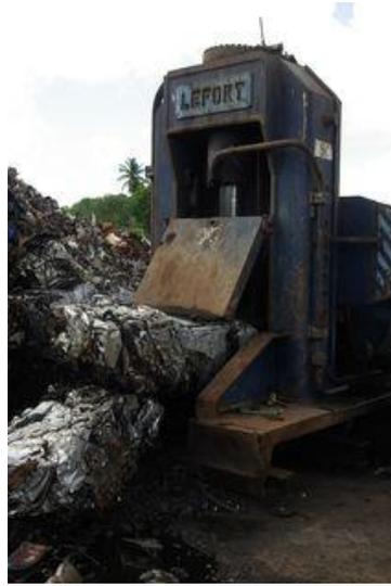
Figure 37: La mise en presse de ferrailles légères-AER- photos Catram
