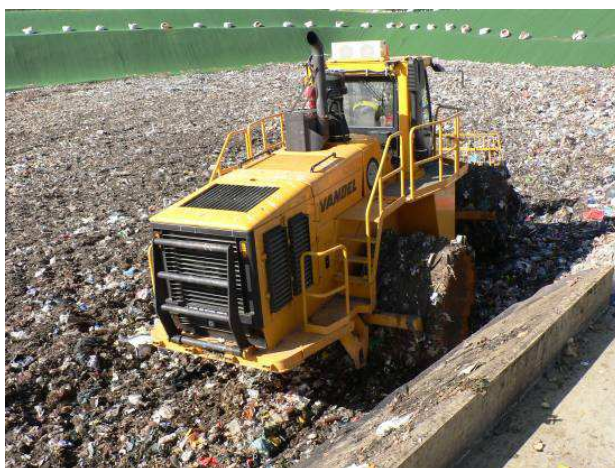
Figure 8. Photo du compacteur VANDEL QS400
