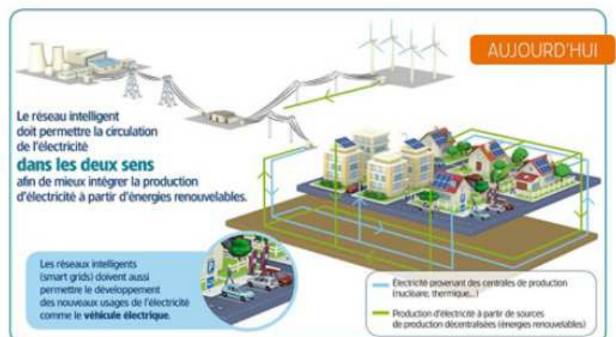
Figure IX.2 : Principe du réseau intelligent - www.erdf.fr
