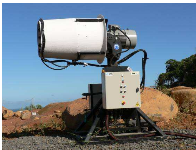
Figure 9. Photo d'un canon pulvérisateur de produit neutralisant
