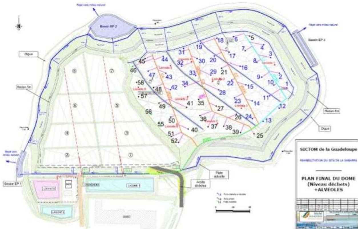
Figure 11: Plan final du massif de déchets réhabilité (Zone 1) avec intégration du casier (Zones 2 et 3)
