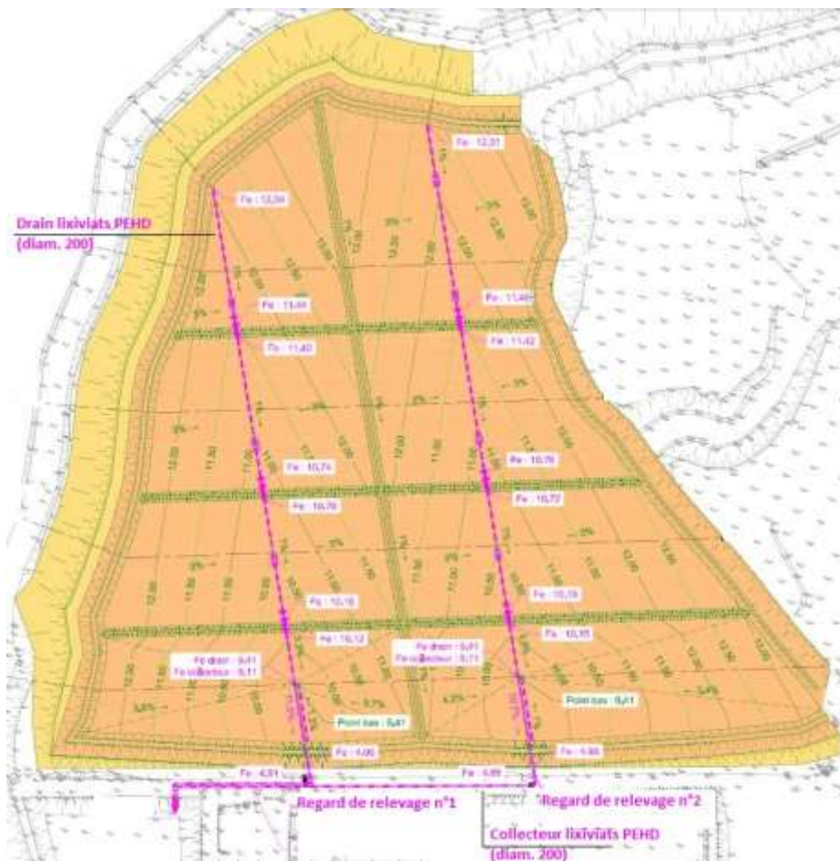
Figure 14: Réseau de gestion des lixiviats du casier de stockage de déchets
