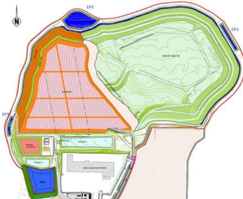
Figure 20: Localisation des 3 bassins d'eaux pluviales
