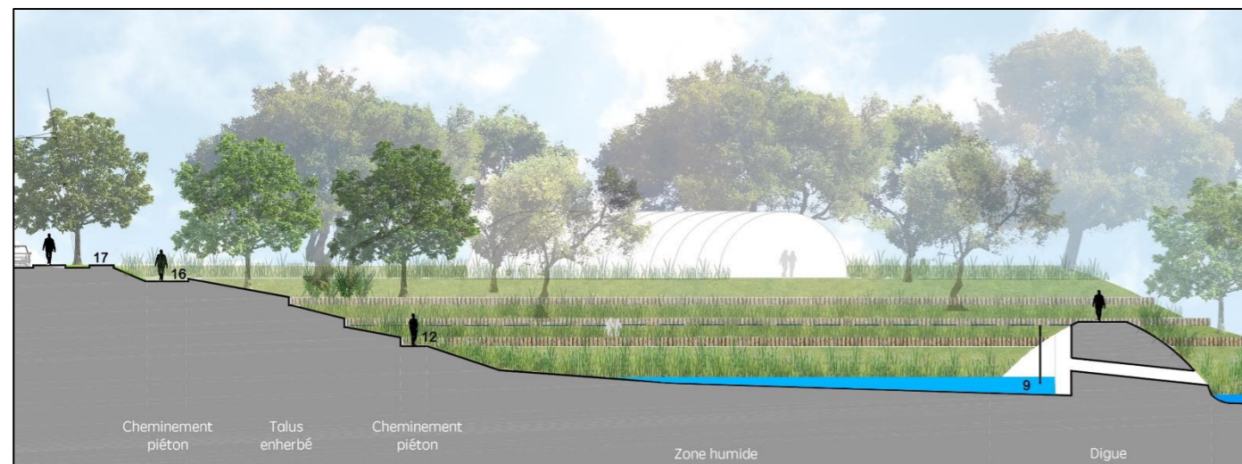
Figure 24 : Coupe schématique du bassin de rétention final (Coupe CC')
