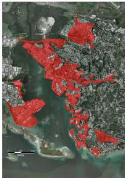
Figure 36 : Cartographie globale des zones gagnées sur la mer et de remblaiement sur mangrove (Source : GEOMAT Antilles)
