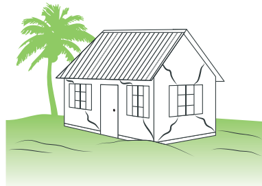
Figure 17 : Rupture des murs résistants (séisme)
