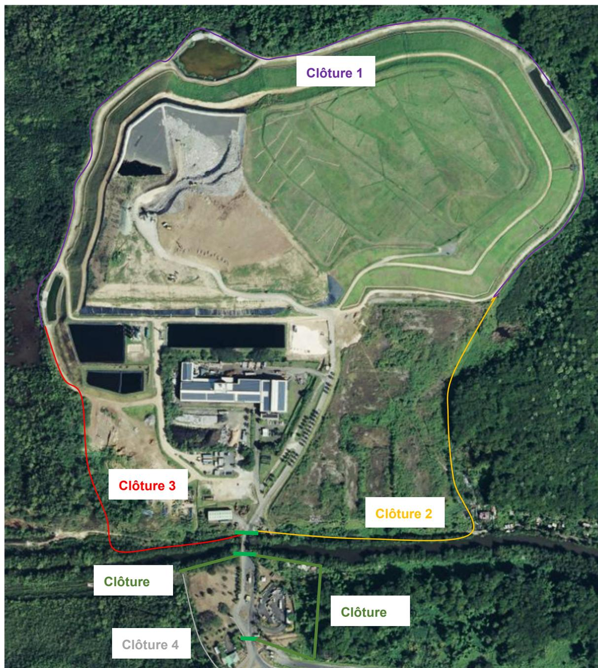
Figure 21: répartition des différentes clôtures à mettre en place sur le site de la Gabarre
