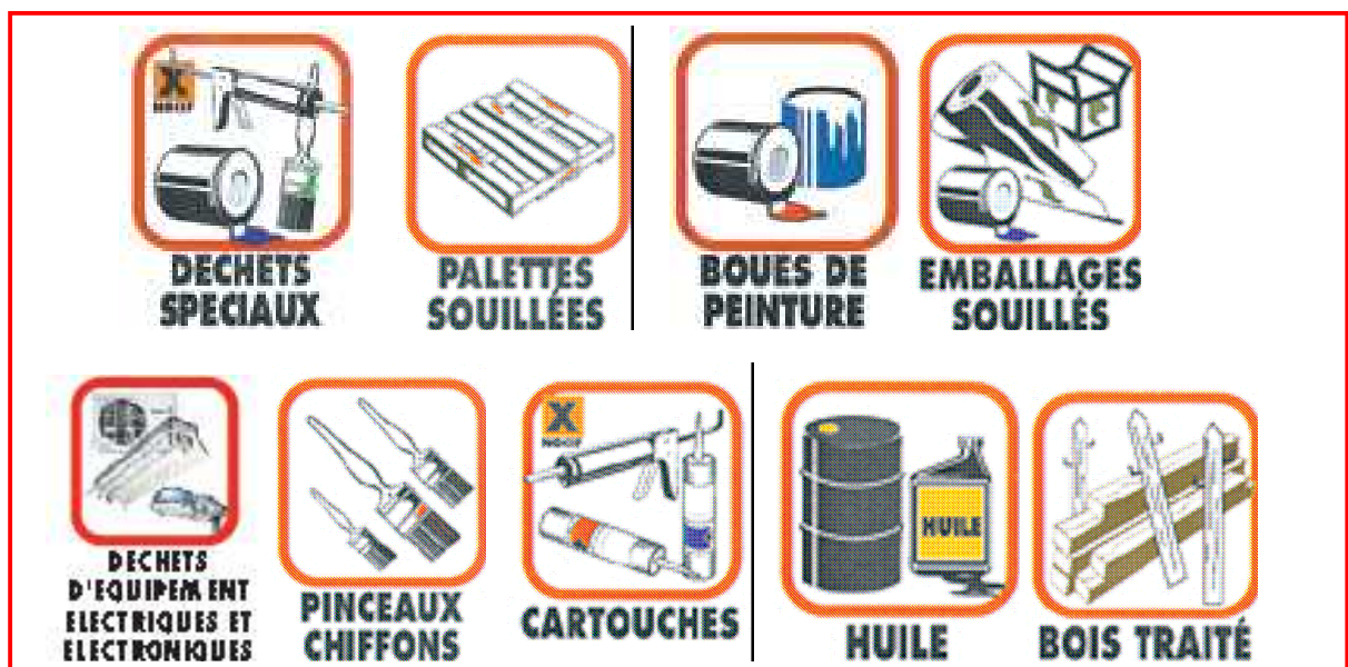
Figure n° 4 : Pictogrammes des déchets dangereux du BTP (source : FFB)
