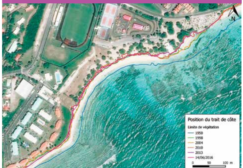
Carte 2 représentative de la variation du traits de côte correspondant à la limite de végétation entre 1950 et 2016 (Fond orthophotographique de l'IGN© 2015)
