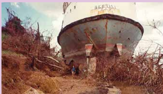
Photographie 1 : Le BERTINA (1600 tx) échoué à Baie Mahault lors d'HUGO (17/09/1989), témoigne d'une surcote de 2,5 m à 3m au fond du Grand Cul de Sac Marin.
