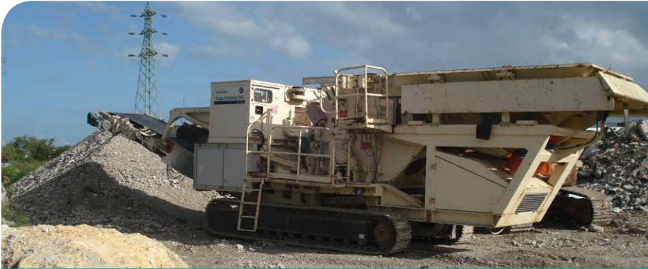
Concasseur de déchets inertes, SGB, Baie-Mahault
