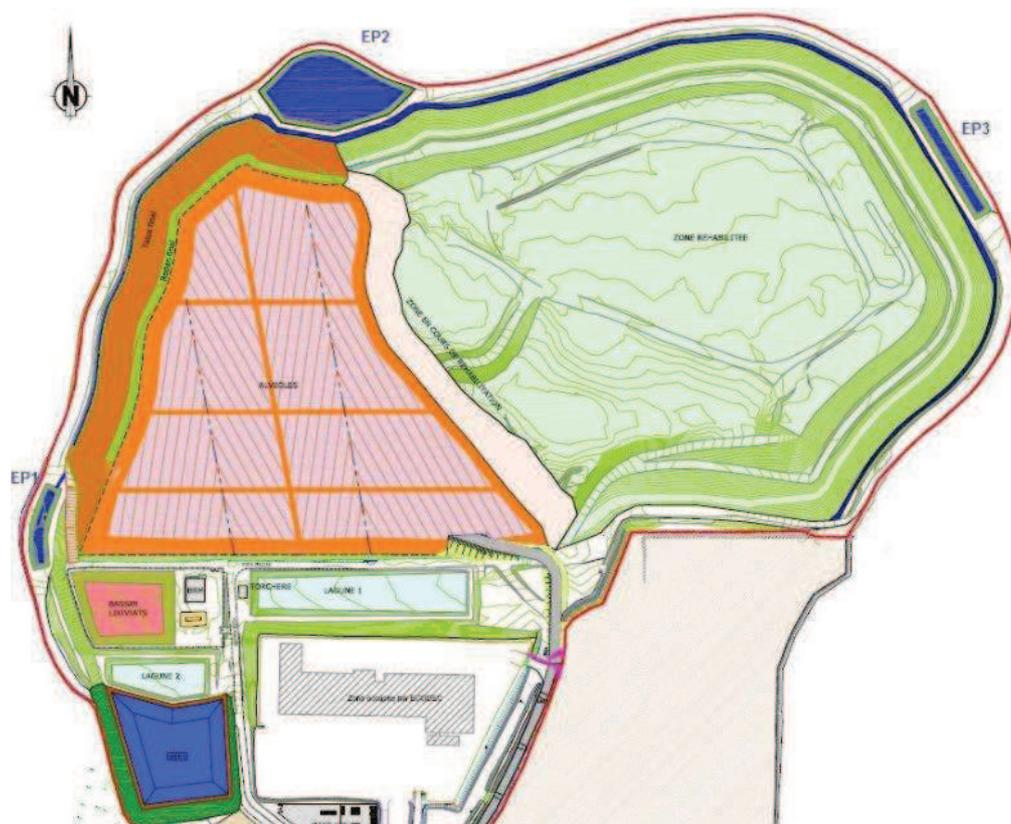
Figure 23 : Localisation des 3 bassins d'eaux pluviales
