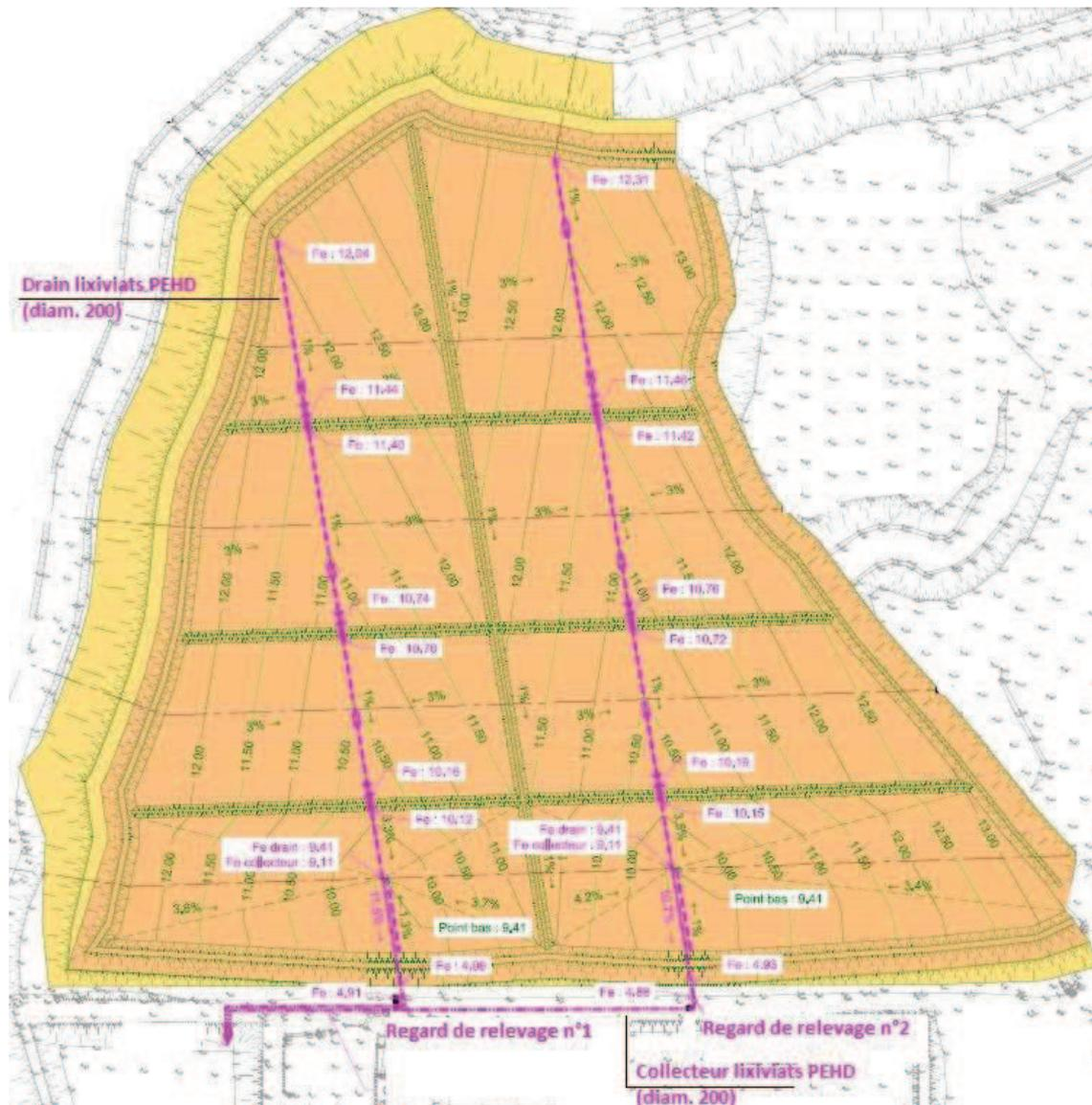
Figure 17 : Réseau de gestion des lixiviats du casier de stockage des déchets
