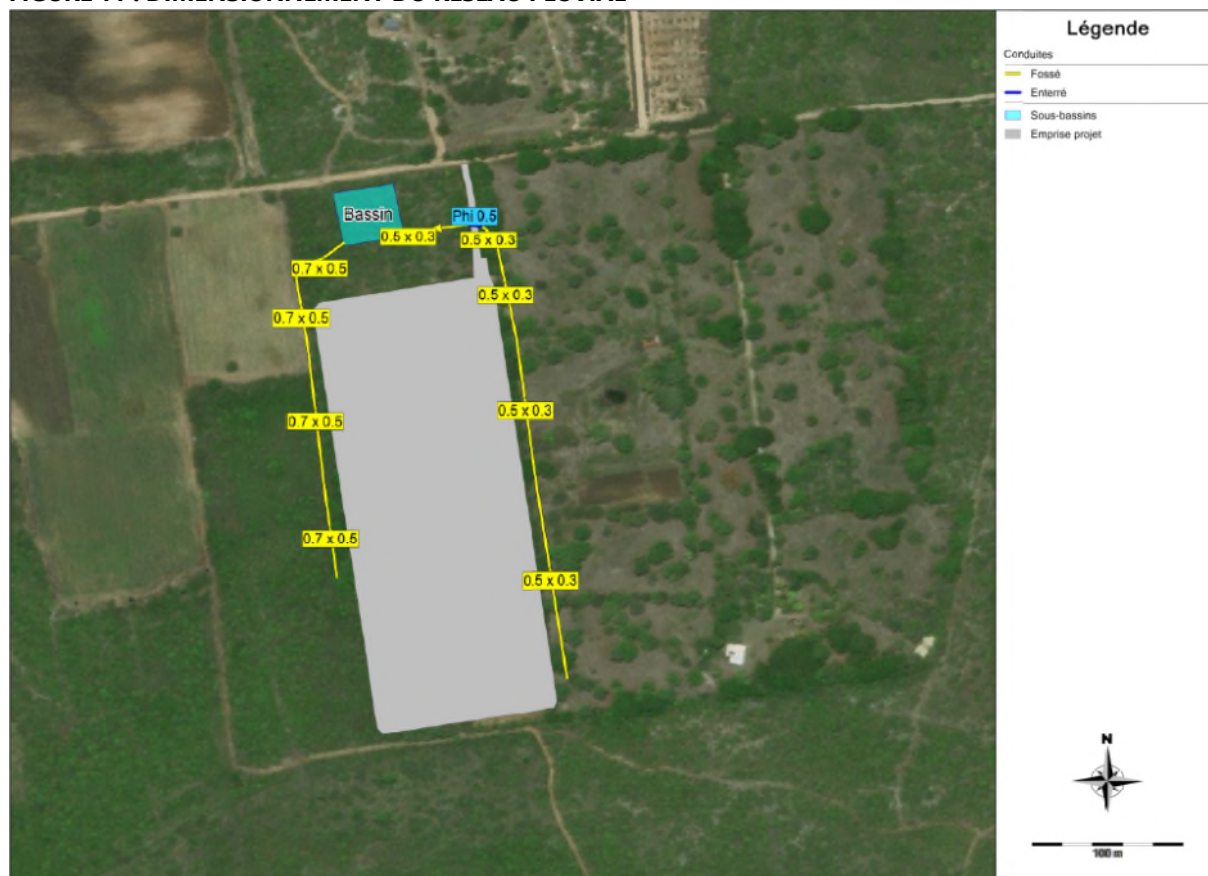
FIGURE 11 : DIMENSIONNEMENT DU RESEAU PLUVIAL
