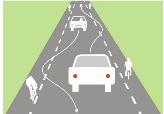
Principe de fonctionnement d'une CVCB
