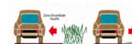
*La présence « d'obstacles » en bord de chaussée incite le conducteur à s'éloigner du bord de chaussée*
