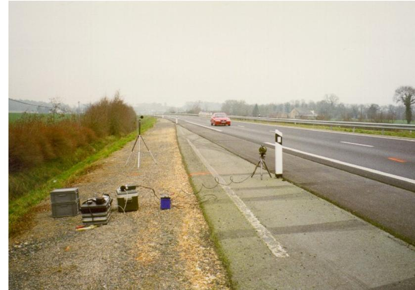
**Mesurage d'un échantillon de véhicules
