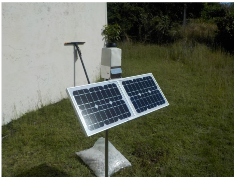
Photo : Capteur de surveillance H 2 S & NH 3 , quartier Fond Savane, commune du Robert, 7 janvier 2016
