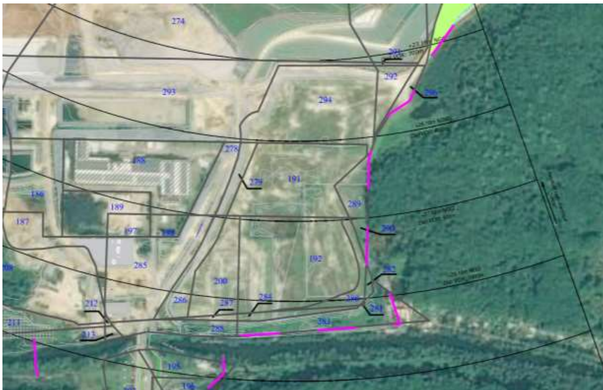
Figure 5 : Plan des niveaux maximum autorisés en présence du VOR au droit du futur casier Sud-Est – Cotes autorisées à augmenter de +5 m suite à autorisation précédente
