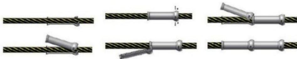
Figure 22 : Procédure d'installation des coques de protection sur le câble
