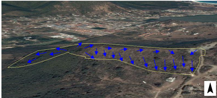
Figure 29 : Ecoulement des eaux pluviales sur le site de projet sur photographie aérienne
