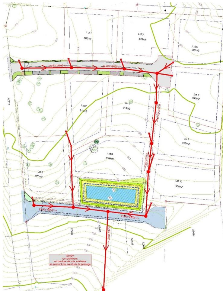
Figure 5: Plan PC du réseau EU-EV projeté
