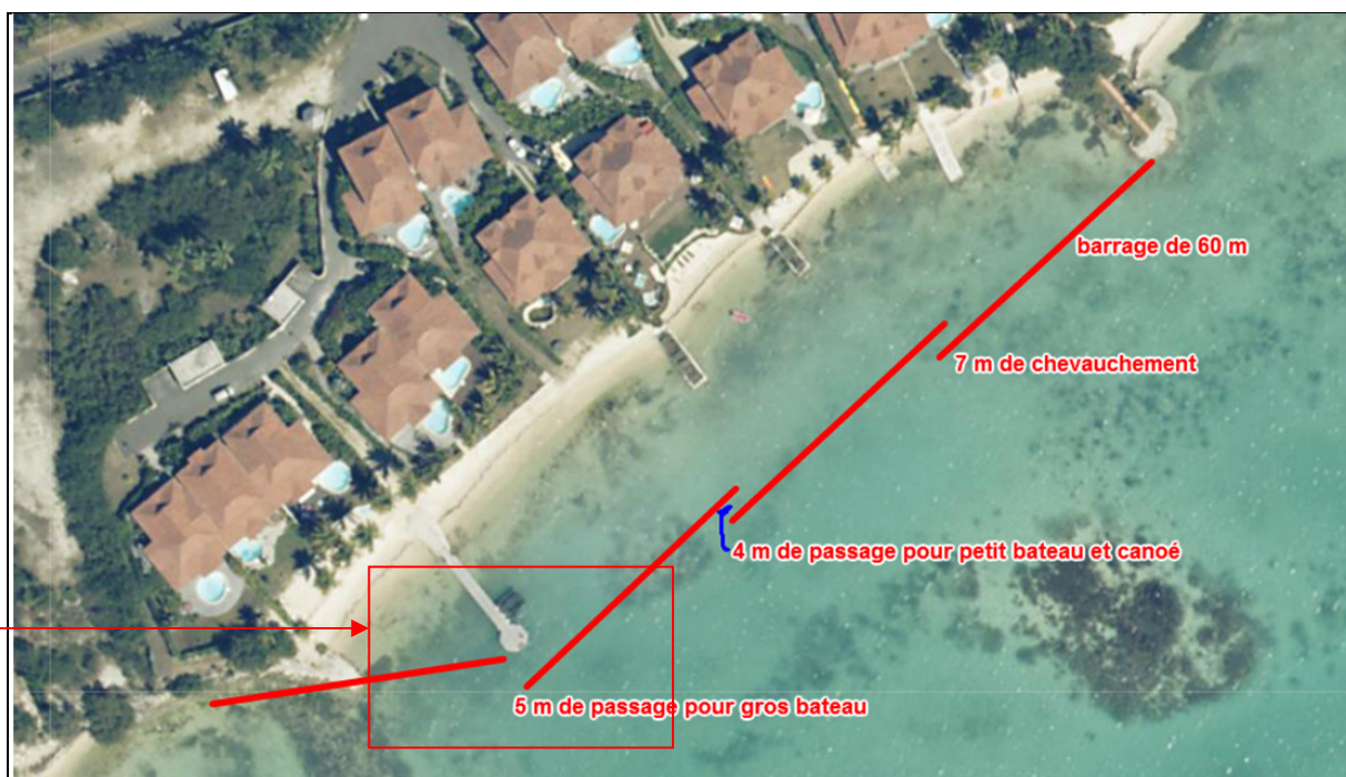
Figure 18: Plan de détail faisant ressortir l'organisation du dispositif de protection anti-algues (source : VillaBoubou, 2015)
