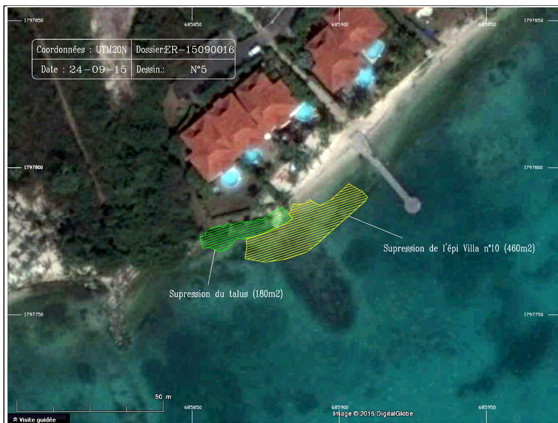
Figure 9 : Zones de déblais au niveau de la Villa n°10 (ERAMM, 24/09/2015)
