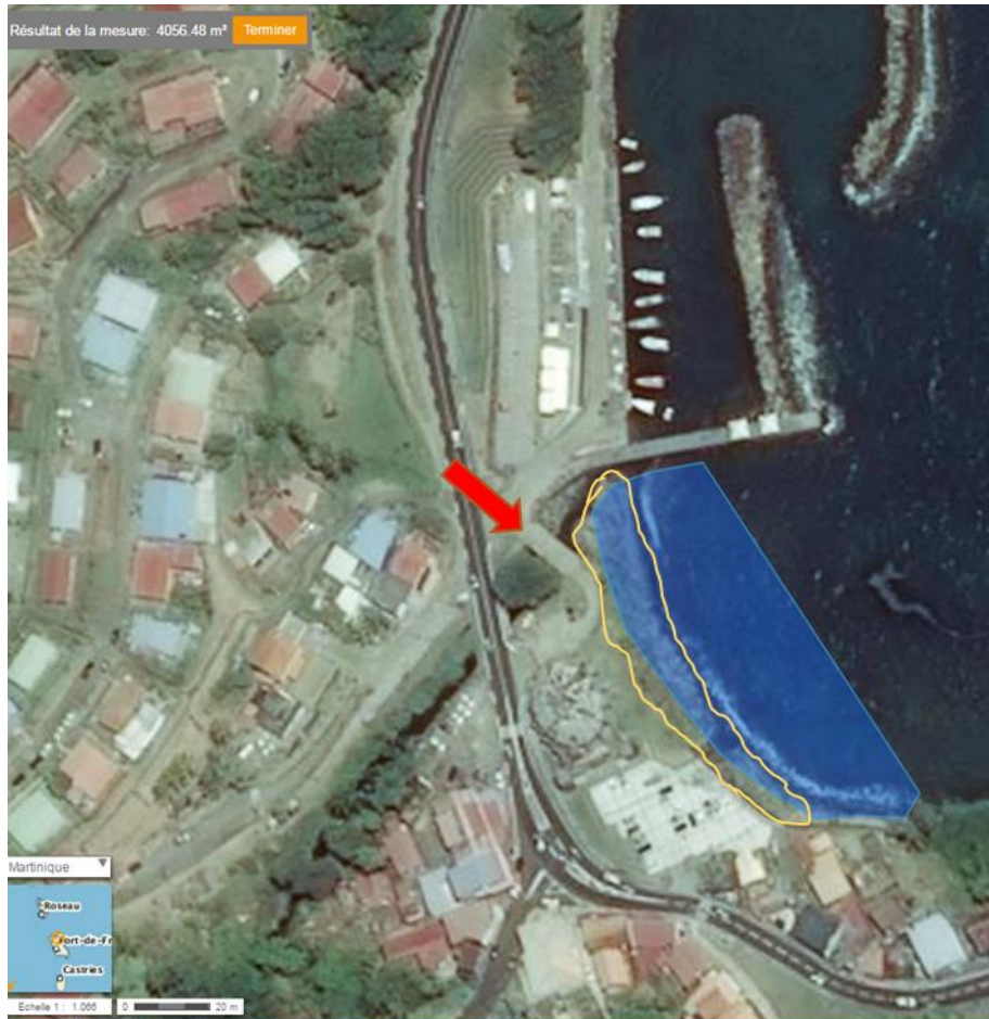
Figure 5: Exemple de cartographie permettant de contextualiser un chantier de ramassage. La flèche rouge indique le point d'accès, le polygone jaune délimite la zone d'enrochement, le polygone bleu délimite approximativement l'aire couverte par les sargasses.
