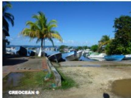
**ANCIENNE CALE DE MISE A L'EAU EN MAUVAIS ETAT ET UTILISEE COMME AIRE DE CARENAGE**
