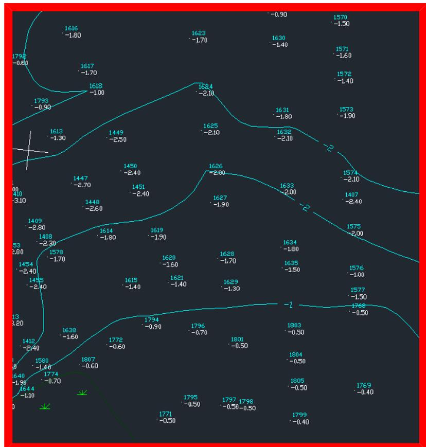
Figure 29 : Extrait de la bathymétrie, zone GCSM / Nord - Tirant d'eau - 2m
