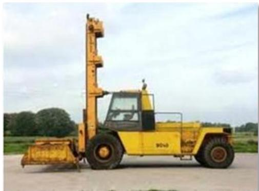
Cette technique se rapproche sensiblement de la manutention des conteneurs maritimes ISO mais en valorisant les bennes existantes. Afin d'éviter l'investissement d'un engin à chaque extrémité de la partie maritime du transport, le chariot élévateur pourrait être transporter avec les bennes, utilisant l'espace d'une benne à bord du navire.
