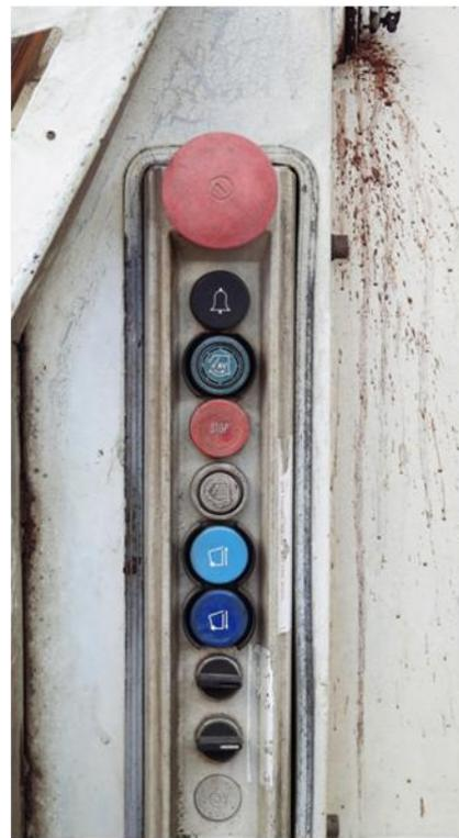
Figure 21: commandes à l'arrière d'une BOM, Source: Catram
