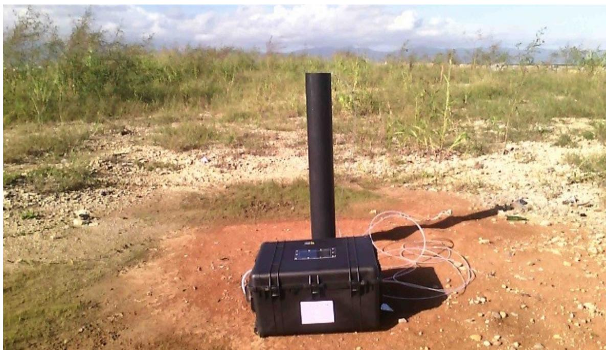
Figure 4 : Photographie(s) - Echantillonnage – Puits (captage de biogaz) casier en cours de réhabilitation
