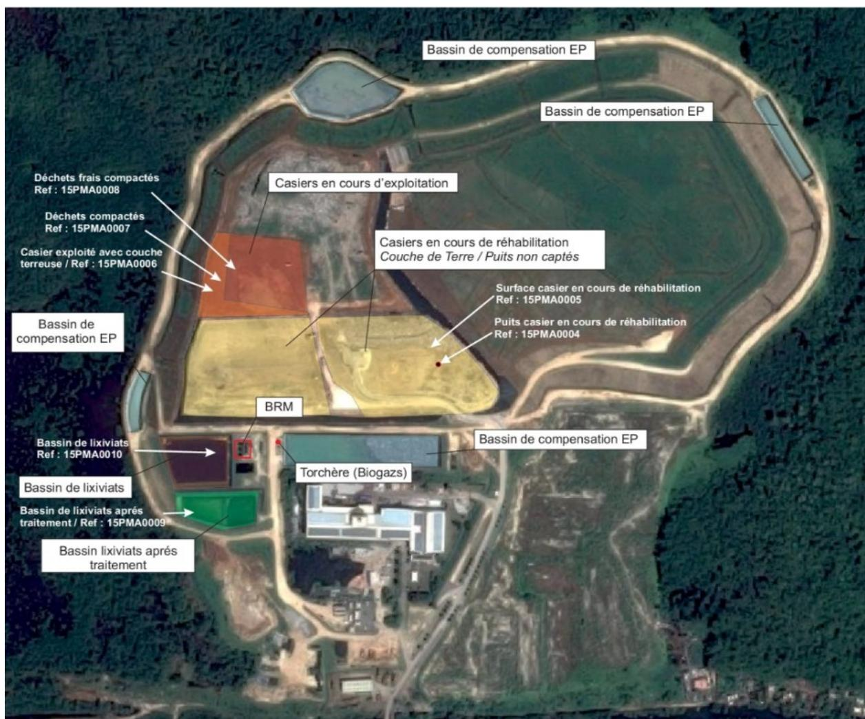
Figure 3 : Plan des installations et points d'échantillonnage
