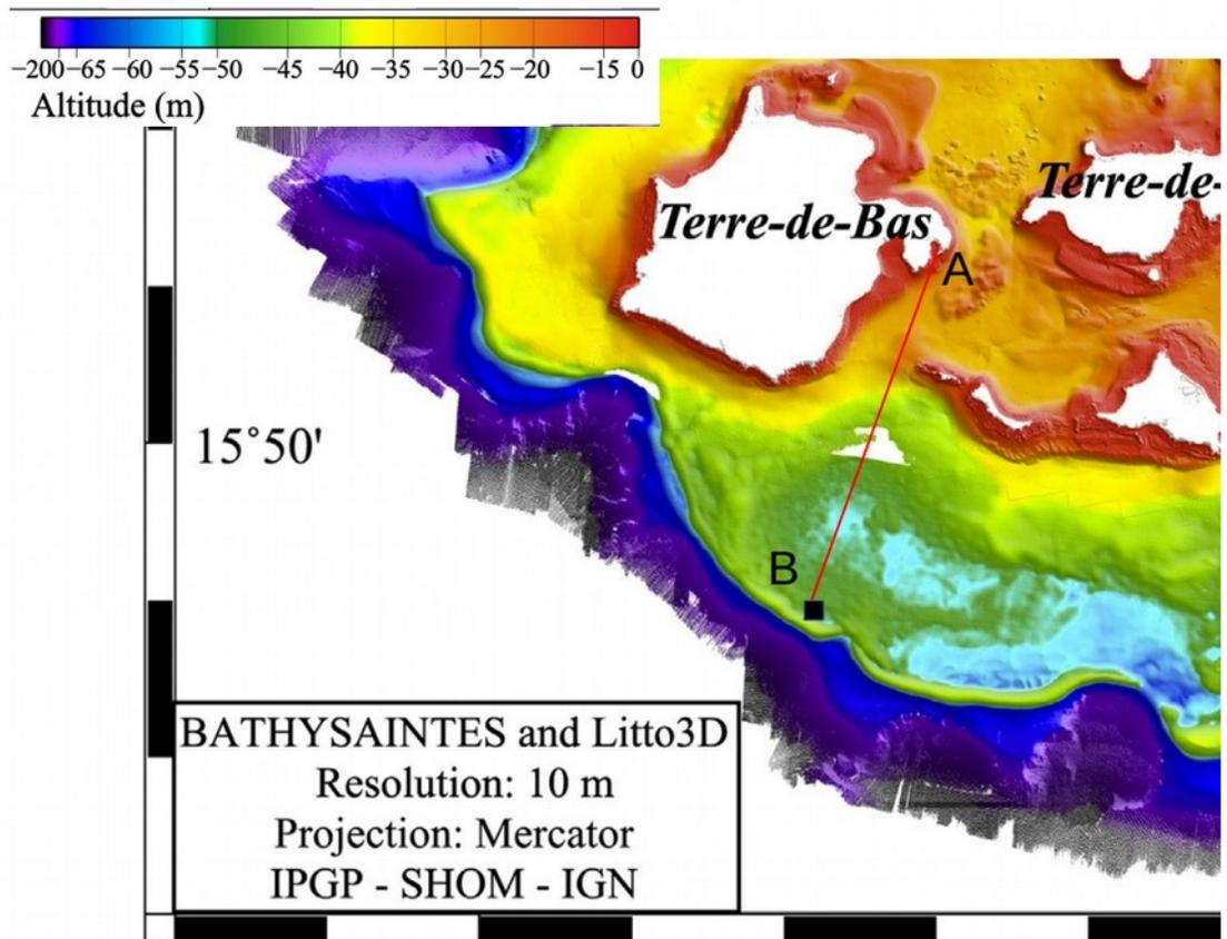
**Plan de situation du câble optique en domaine marin sur fond bathymétrique haute résolution**
