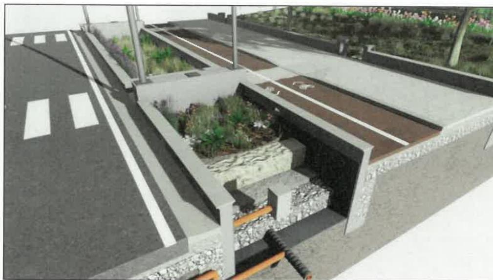
Figure 14 : Chaussée à structure réservoir avec ruissellement vers jardins de pluie
