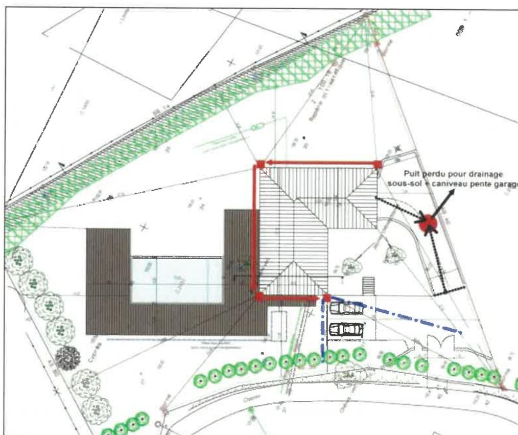
Figure 15 : Placement des gouttières de drainage des eaux pluviales
