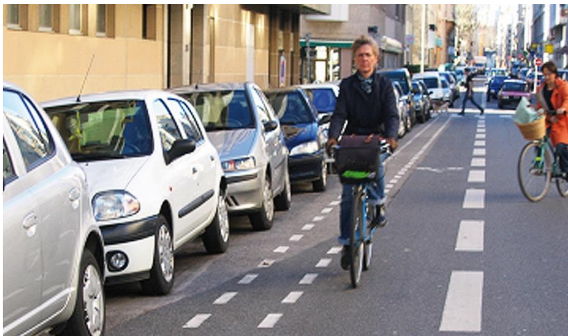
Bande cyclable avec espace tampon de 0,5 m
