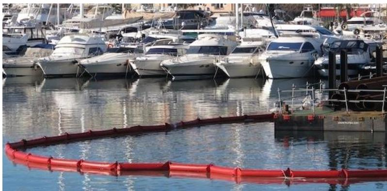
Figure 11 : Exemple de barrière flottante anti-pollution telle que prévue.
