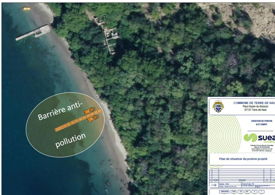
**Figure 12 : Implantation de la barrière anti-pollution prévue dans le cadre des travaux**
