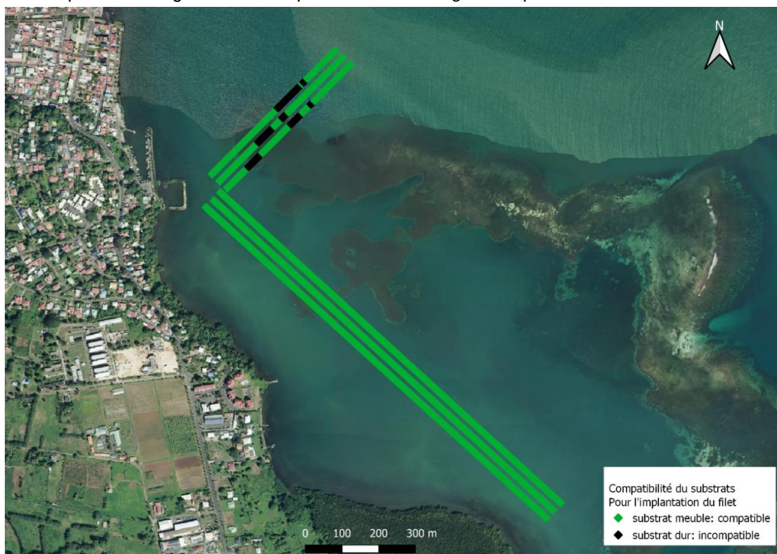
Figure 32 : Délimitation des substrats compatibles et incompatibles avec la pose de corps-morts
