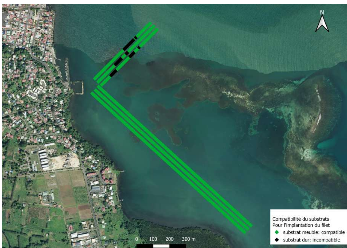
Figure 15 : délimitation des substrats compatibles et incompatibles avec la pose de corps-morts
