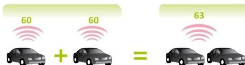
Figure 3 : Doublement de l'intensité sonore (source : EGIS/ACOUSTB)
