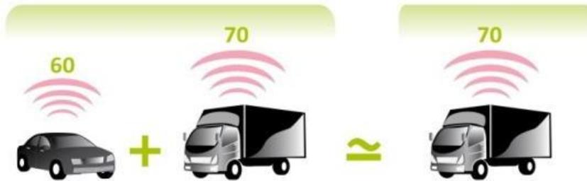
Figure 4 : Deux sources d'intensité différente (source : EGIS/ACOUSTB)
