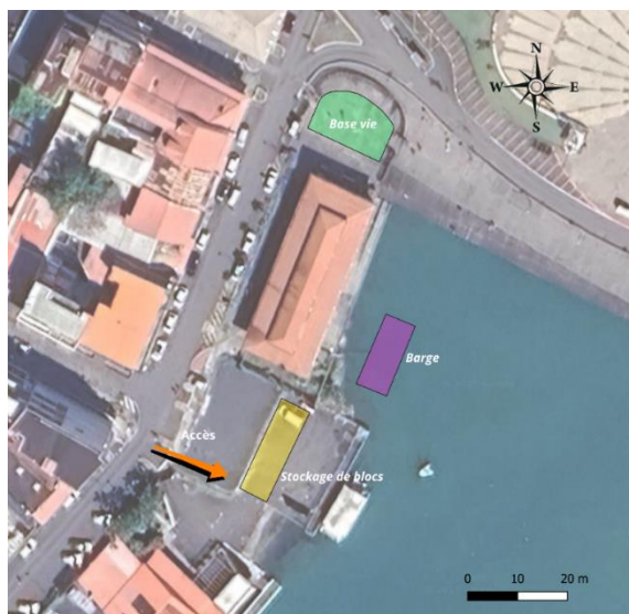
Figure 12 : Accessibilité et installation de chantier
