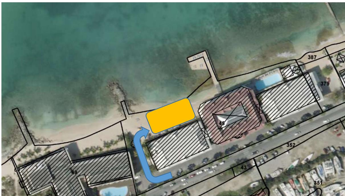
Figure 5 : Localisation de l'aire de chantier et de stockage temporaire et de l'accès pour les engins de chantier aux zones de travaux
