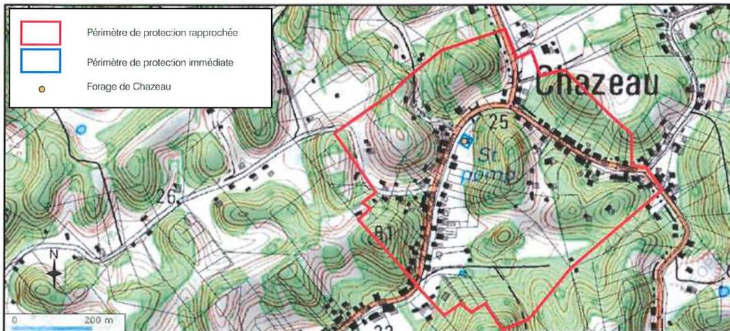
Figure 44 : Périmètre de protection du captage de Chazeau (Source : ARS)
