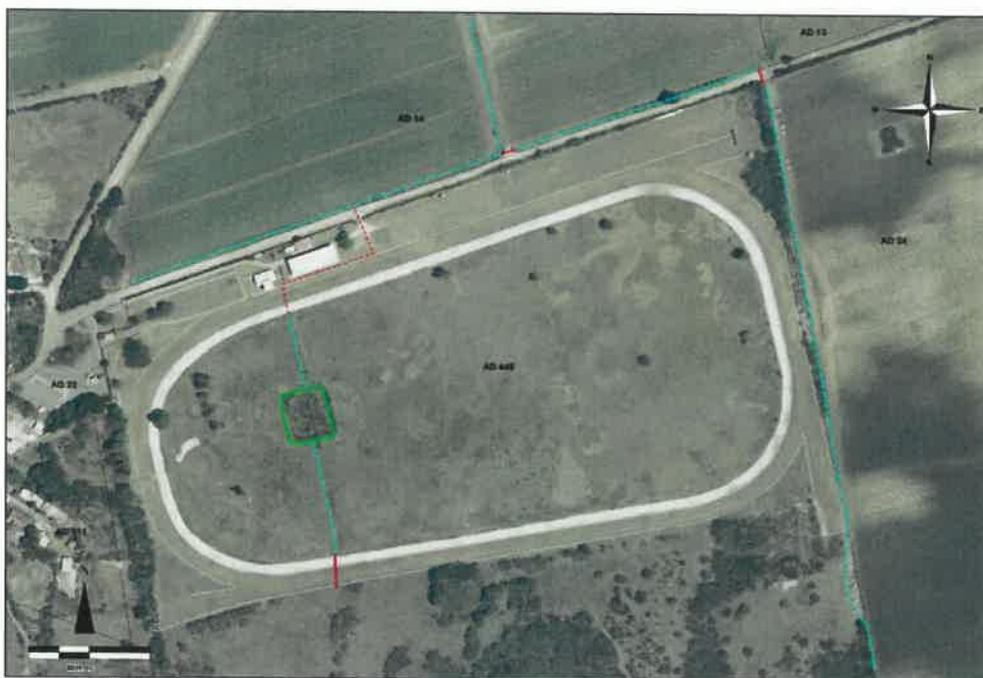
Figure 12 : Inventaire et localisation des ouvrages hydrauliques de collecte des eaux pluviales sur le site de l'hippodrome, source : Expertise hydraulique Phase 1 : diagnostic hydraulique et travaux d'urgence, Conseil Régional, SAFEGE, Février 2012
