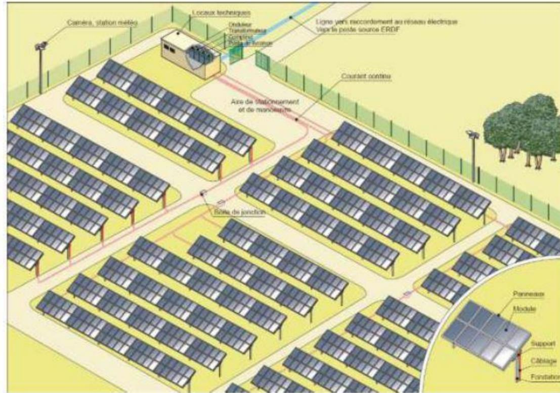
Figure 11 : Schéma de principe d'une installation photovoltaïque
