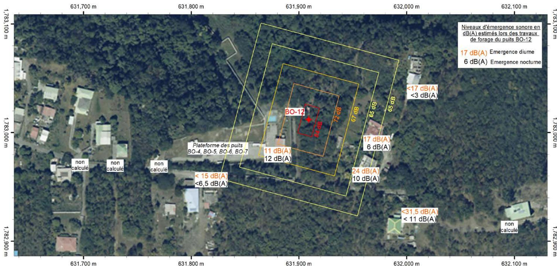
Figure 68 : Estimation des niveaux d'émergences sonores lors des travaux de forage autour du site du puits BO-12 en périodes diurne et nocturne, **avant application de mesures correctrices.**
