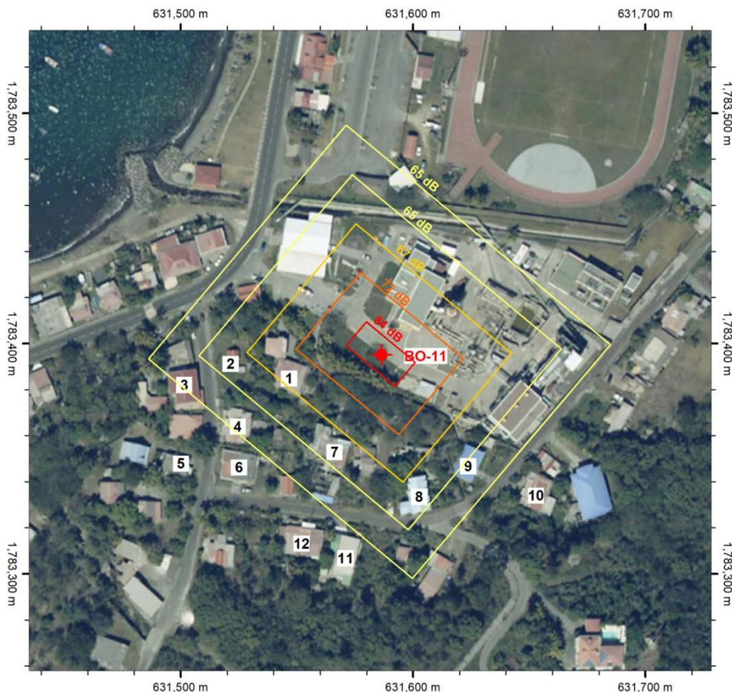
Figure 65 : Représentation des niveaux de bruit générés par la machine de forage en fonction de la distance autour du site du puits BO-11, en **l’absence de mesures correctrices** (Document Ormat).
