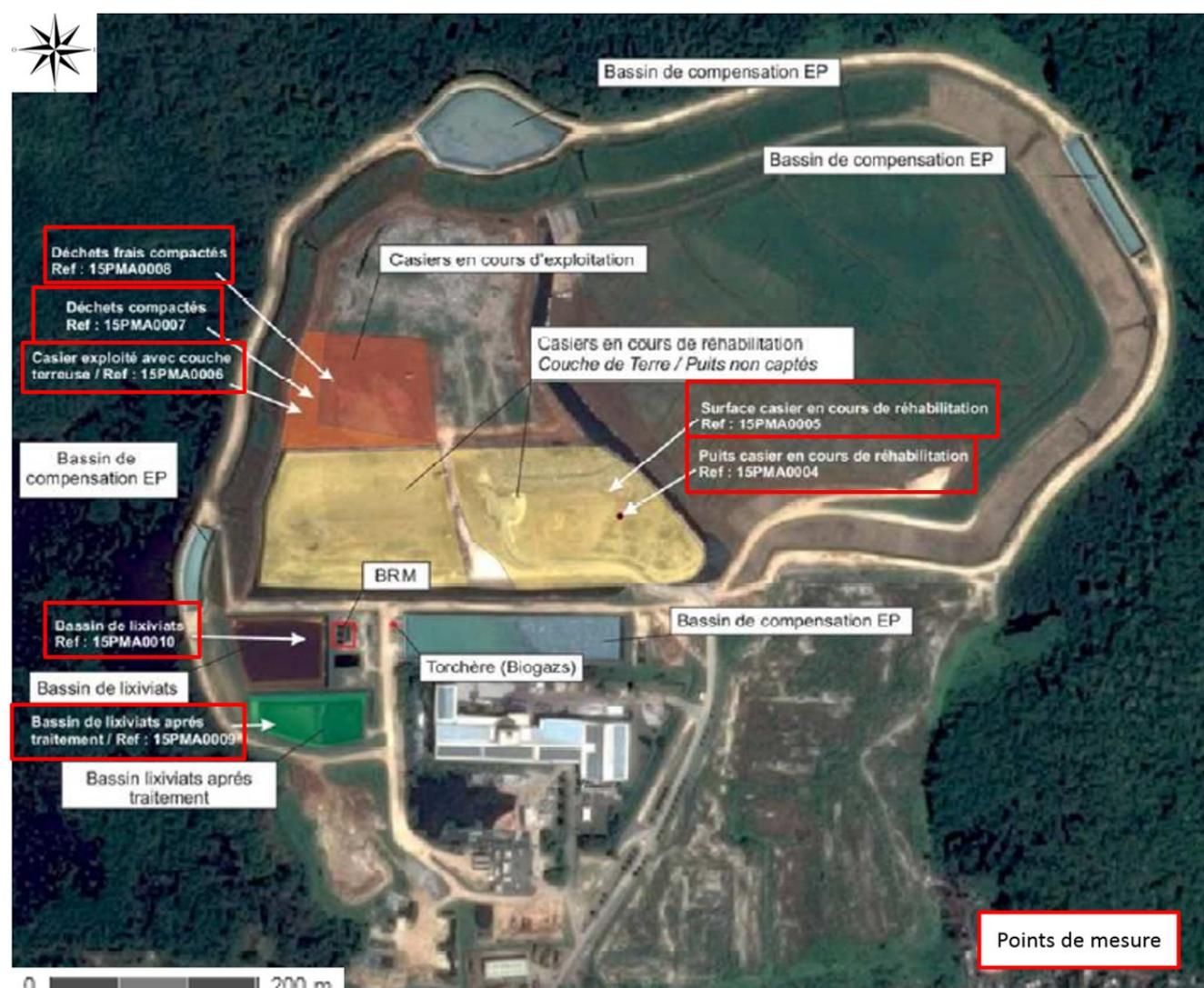
Figure 41 : Pan reprenant les installations de l'ISDND et les points d'échantillonnages pour les mesures olfactives
