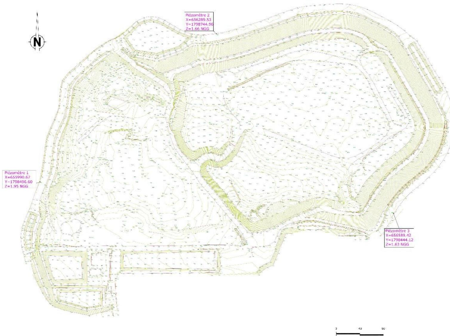
*Figure 24 : Plan d'implantation des piézomètres de la Gabarre*
