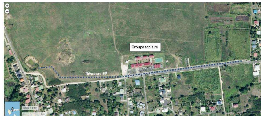
Figure 88 : Réseaux d'eaux pluviales au sud du site
